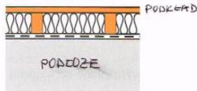
Rys. 3.7. Podkład deskowy oddzielony podniesiony
