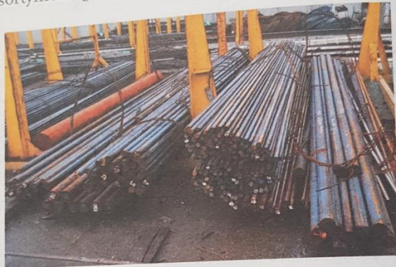
Rys. 3.23. Składowanie prętów stalowych
