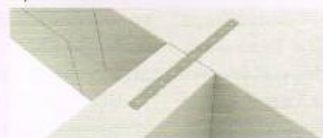
Ścianę działową łączy się ze ścianą nośną za pomocą metalowych łączników do ścian działowych
