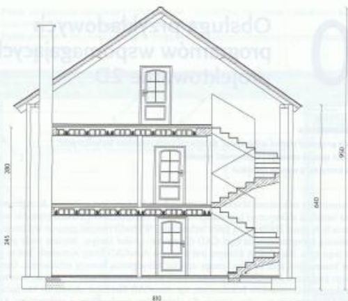
Rys. 29.2. Przekrój pionowy budynku
