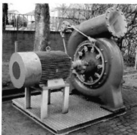
Rys. 380. Widok i przekrój turbiny Francisa [304]
