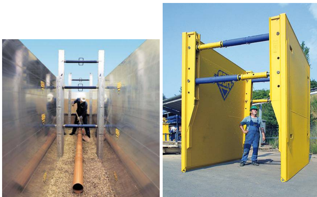
Rys. Obudowy wykopów prefabrykowane: po lewej obudowa typu lekkiego aluminiowa dla wykopów o głębokości do 3m, po prawej obudowa typu SBH stalowa do 4m.
