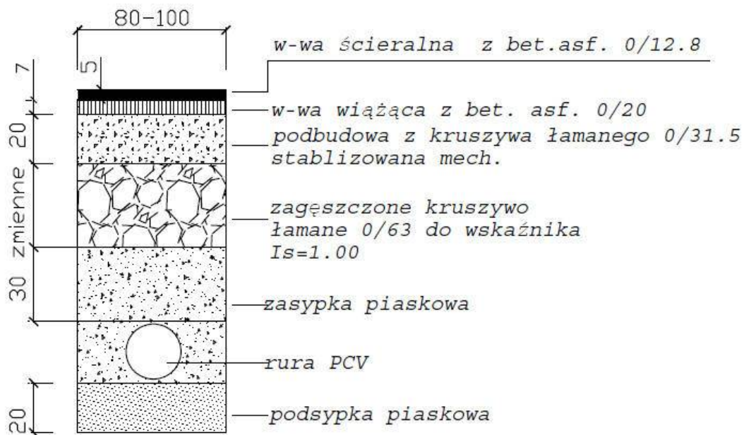
Rys. Przekrój przez wykop z rurą kanalizacyjną ułożoną pod jezdnią.
