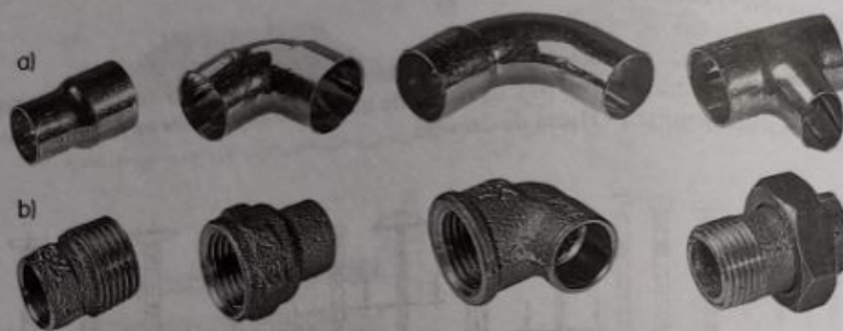
Rys. 2.51. Łączniki miedziane do instalacji gazowych (fot. Ryszard Piątkowski/WSiP): a) kielichowe łączniki do łączenia rur miedzianych lub zmiany ich kierunku, b) łączniki z brązu lub mosiądzu do łączenia rur miedzianych z armaturą i odbiornikami gazu
