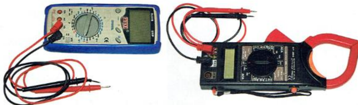
Rys. 1.6. Miernik elektroniczny: a) standardowy, b) cęgowy
