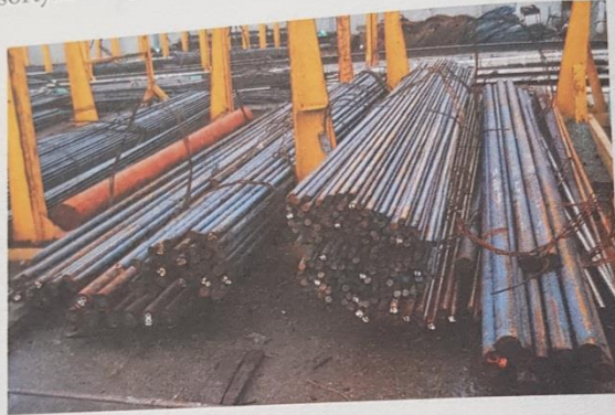
Rys. 3.23. Składowanie prętów stalowych
