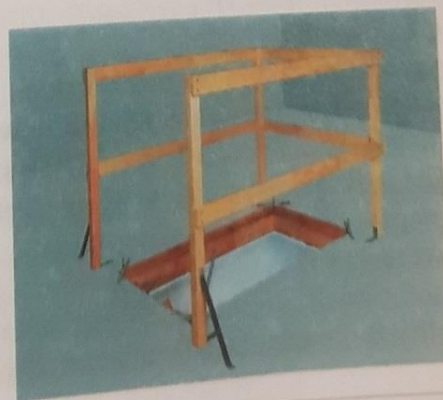
Rys. 3.40. Zabezpieczenie otworu w stropie i dachu stałymi balustradami
