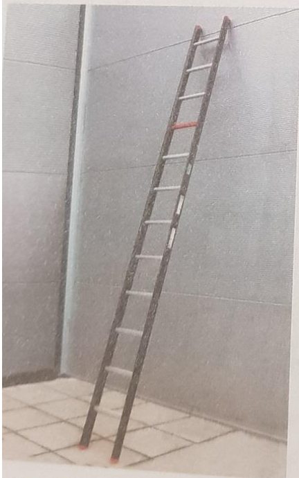
3.35. Prawidłowy kąt ustawienia drabiny według zasady 1 na 4
