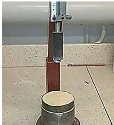
Penetrometr do oznaczania konsystencji zaprawy
