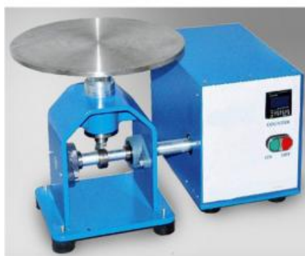
Stolik wstrząsowy do oznaczania konsystencji zaprawy metodą rozplywu
