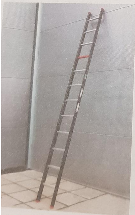
3.35. Prawidłowy kąt ustawienia drabiny według zasady 1 na 4
