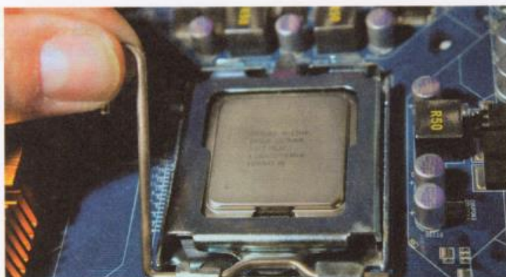
Rys. 42.4. Montaż procesora w gnieździe
