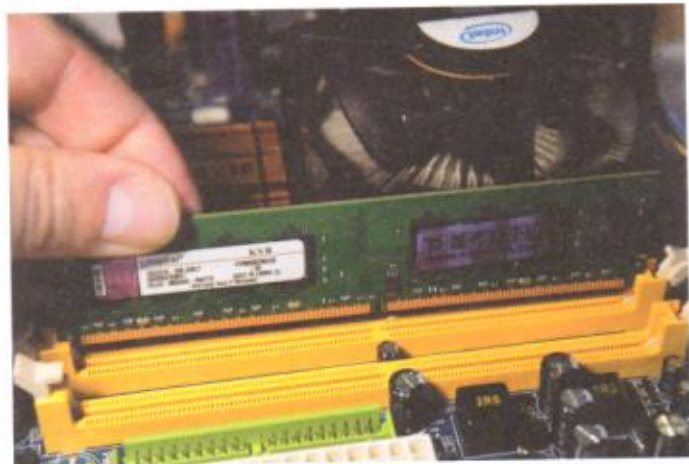
Rys. 42.8. Ustalenie położenia modułu pamięci
