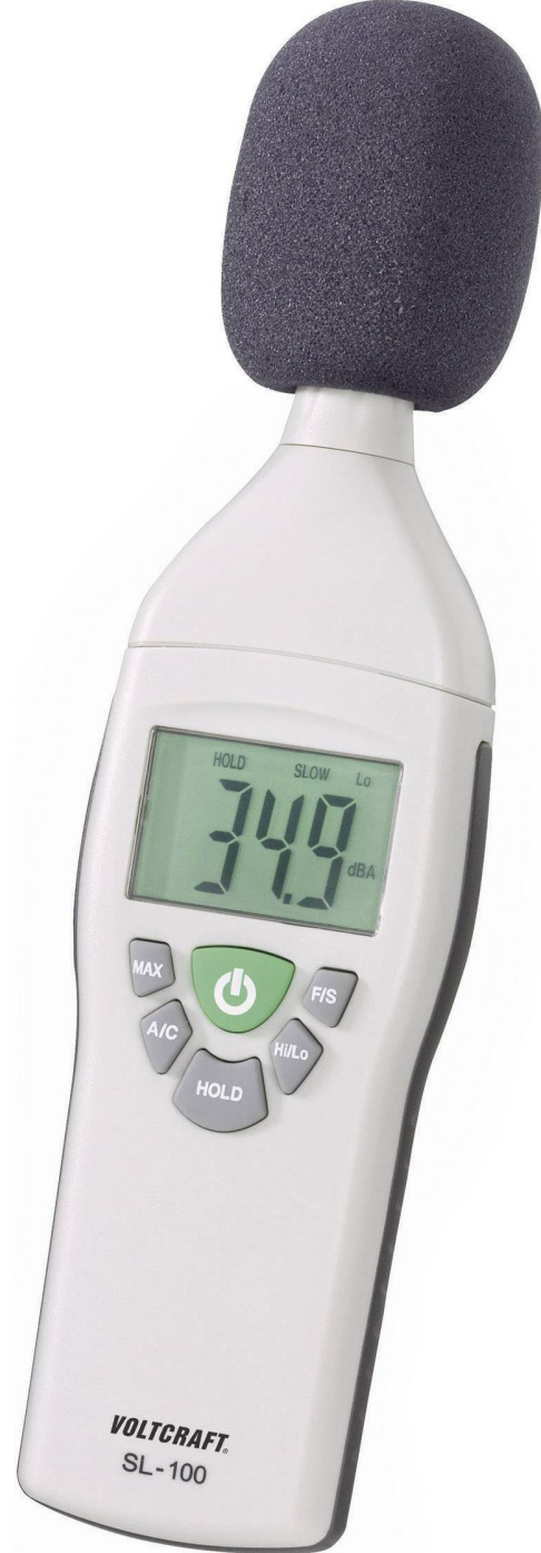
Decybelomierz (sonometr) – do pomiaru natężenia dźwięku, w dB.
