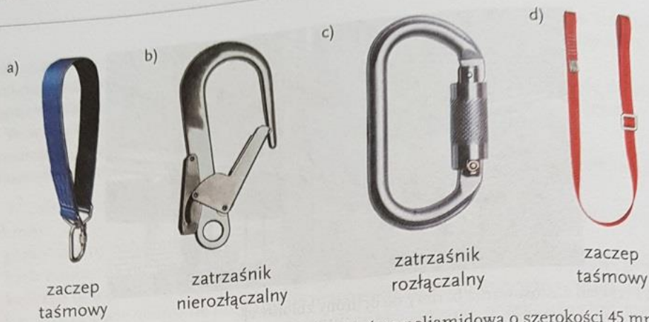
Rys. 4.18. Przykłady podzespołów kotwiczących: a) taśma poliamidowa o szerokości 45 mm z antypoślizgową gumową warstwą ochronną naniesioną na wewnętrzną stronę zaczepu; b) zatrzaśnik ze stali z zapadką blokującą – otwarcie 50 mm; c) zatrzaśnik ze stali z zapadką blokującą – otwarcie 18 mm; d) taśma włókiennicza o szerokości 20 mm, 30 cm, 60 cm, 80 cm, 120 cm, 150 cm i 200 cm
